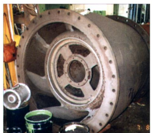
ขอบครีปของตัวปล่อยพิวส์ ถูก สร้างใหม่ด้วย TITANIUM PUTTY
