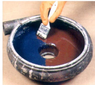
ตัวเรือนปั๊มที่เคลือบด้วย BRUSHABLE CERAMIC
