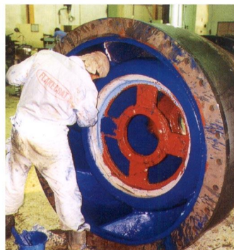
ตัวเรือนปั๊มที่เคลือบด้วย BRUSHABLE CERAMIC
