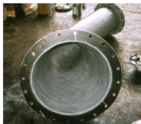
ท่อส่งถ่านหินที่เคลือบป้องกันรอยสึกกร่อนด้วย WEAR GUARD FINE LOAD
